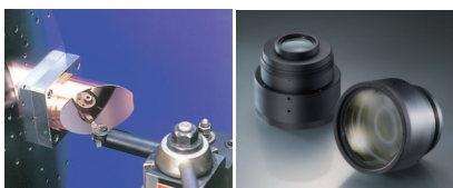
非球面加工 Aspheric Generating
