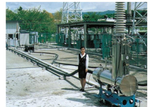
长30米的高温超导试验电缆
