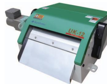
通过磁辊转动，吸附粉末状的磁性切屑，再经过胶辊碾压挤出液体，最终通过刮板将切屑与磁辊分离的设备。以磁场解析技术为基础，借助独创的磁铁排列，实现了高效率的过滤精度。
