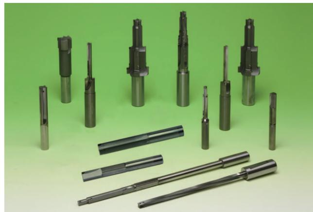
针对工件形状、精度、节拍时间要求制定刀具方案。凭借一体化、多段式刀具设计，可一次性完成多个位置的精加工。并且依靠住友金刚石材质，大幅提高刀具寿命(寿命可达硬质合金材质的 10 倍以上)。
