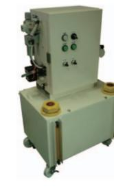
该设备是可将油性、水溶性的两种切削液喷雾化的装置。兼顾润滑和冷却的独有喷雾可以实现高效率的切削加工，在深孔钻孔加工方面效果尤为明显。此外，还可对应符合各种用途的特殊规格。
