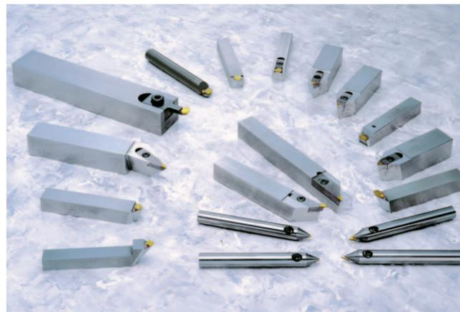
采用住友单结晶金刚石材质，针对刀具用途对单晶金刚石的结晶方向进行人工干预，并通过控制纳米级移动轨迹的刀刃研磨技术，在加工中可实现惊人的直线度和表面光洁度。
