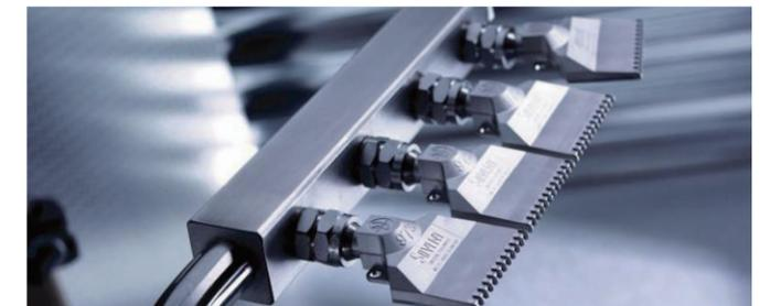
Silvent 的喷嘴可以形成均匀稳定的笔直气流，即所谓的层流。实现强大喷射力、低噪音和较少的能源消耗量。最适合用于切削现场的切屑去除、清洁、清洗后的控水等。
