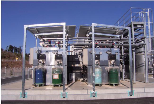
该装置通过对加工现场排出的水溶性切削液、废水、污泥，进行低压蒸发脱水，并将残渣干燥，大幅减少加工产生的工业废弃物，为企业环保减排做贡献。
